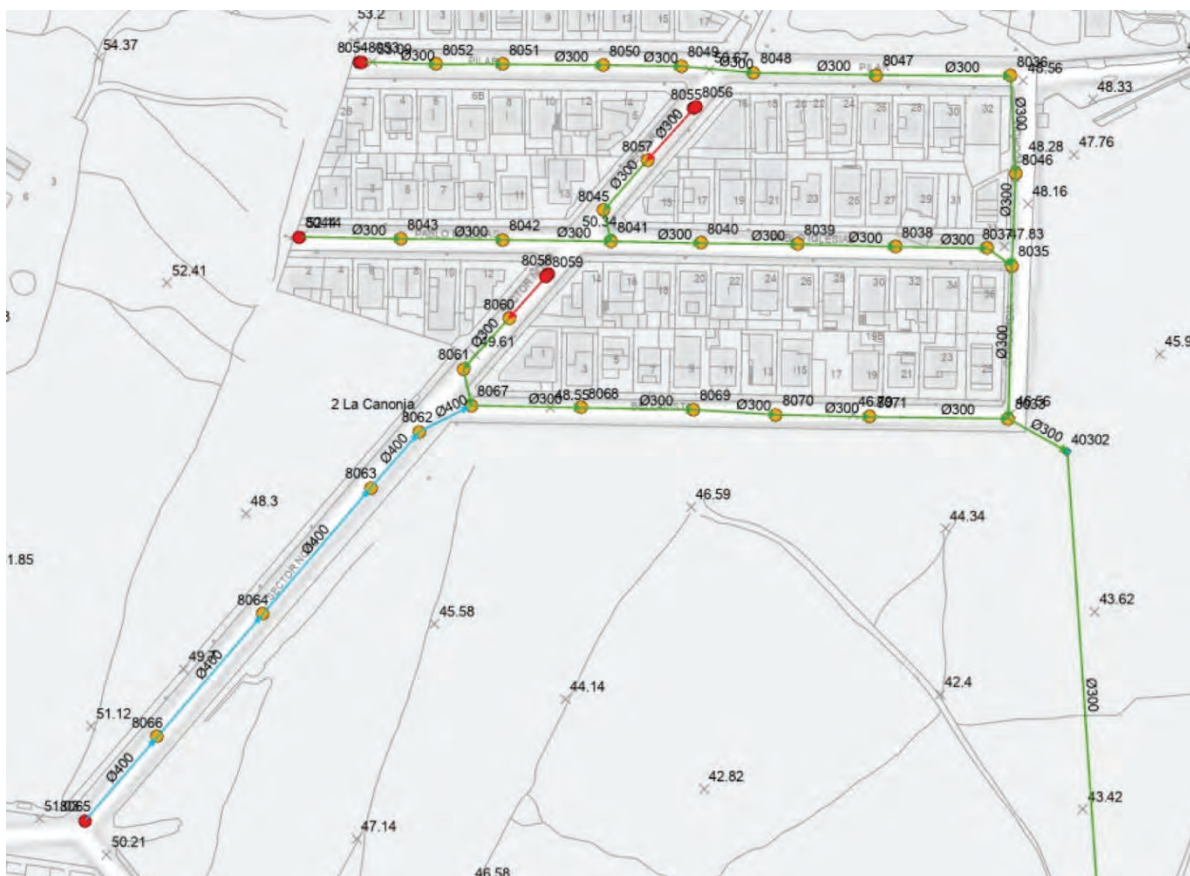
Plànol 4. Estructura, característiques i funcionament de la xarxa de clavegueram existent al sector.
