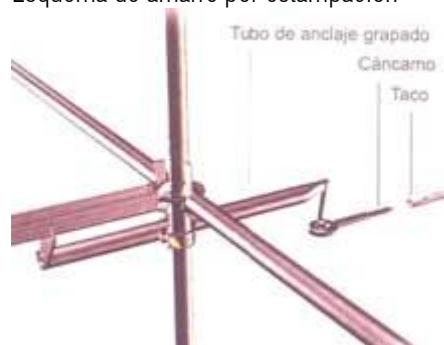
Esquema de anclaje por tacos expansibles
