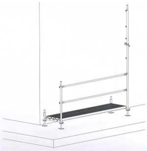
Figura 5 Inserción del marco parcial en l en el elemento de arranque
