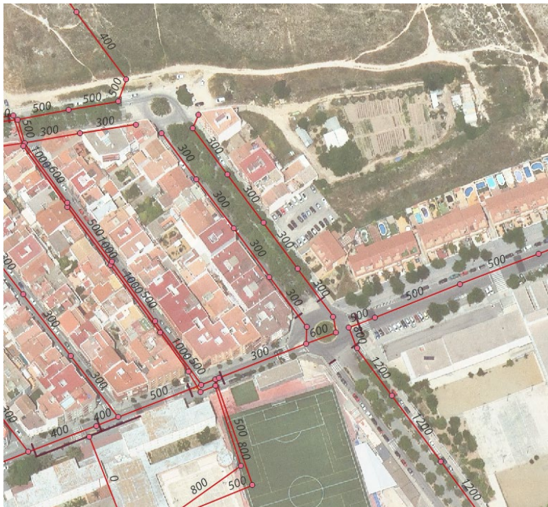
Figura 21. Estat actual dels col·lectors a l'avinguda de Collblanc.
