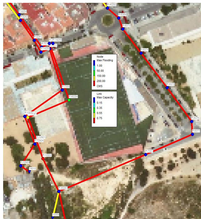
Figura 31. Resultats al tram 3 amb millores. Es representa el cabal sobreexidor dels pous (l/s) i la ocupació del col·lector (tant per u).
