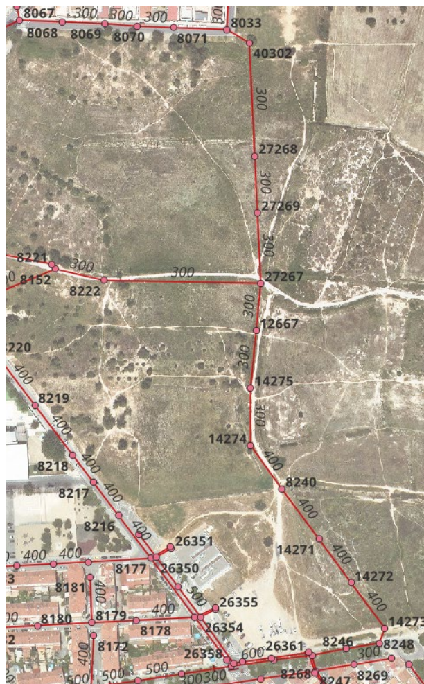
Figura 2. Tram nord del col·lector d'estudi que correspon al tram entre els pous 8033 i 14273.
