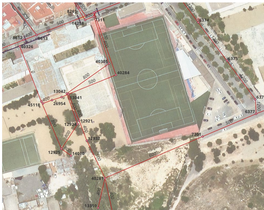
Figura 4. Col·lectors sota el camp d'esports Municipal de la Canonja i l'Escola Pública La Canonja. Sobreeixidor P13359.
