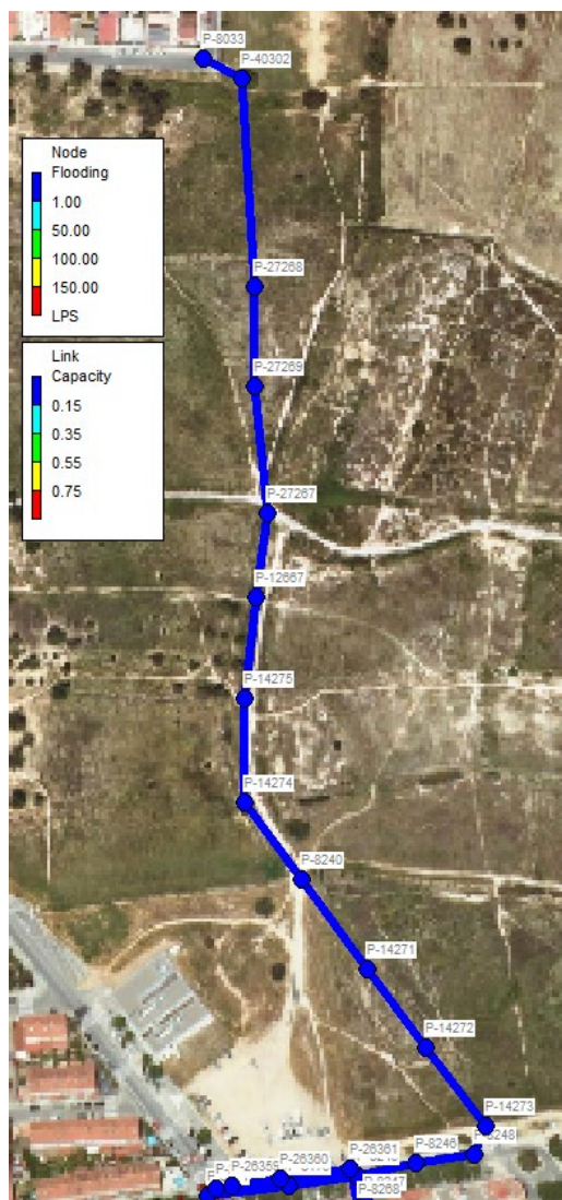
Figura 15. Resultats al tram P-8033 i P-14273 durant temps sec i hora punta. Es representa el cabal sobreexidor dels pous (l/s) i la ocupació del col·lector (tant per u).
