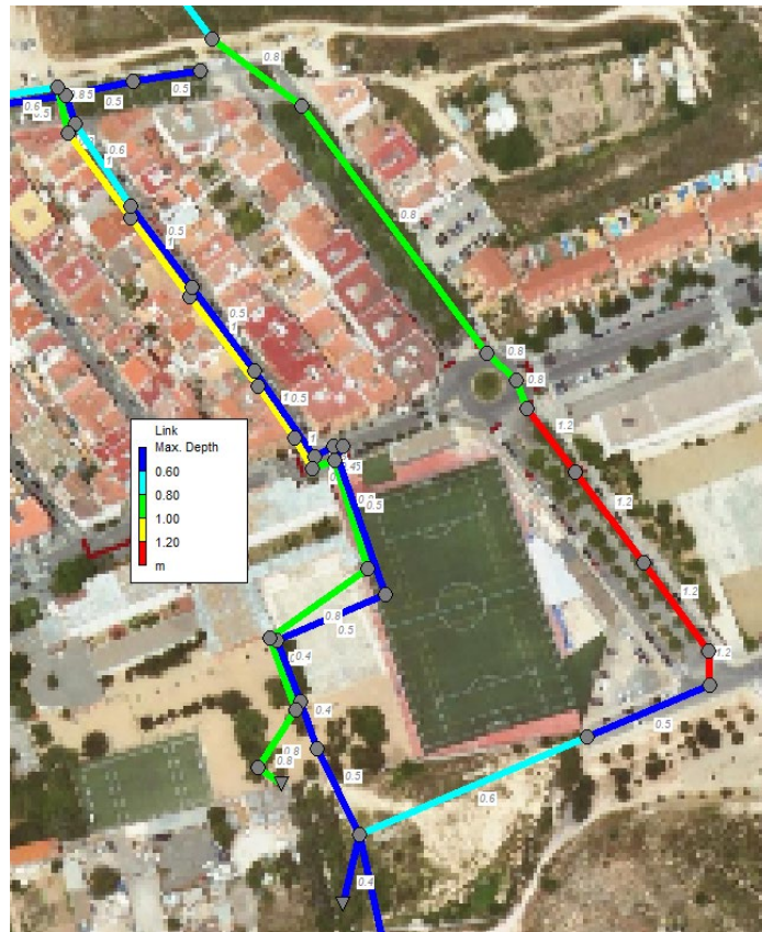
Figura 23. Model SWMM de la xarxa de sanejament de La Canonja amb la proposta de millores.
