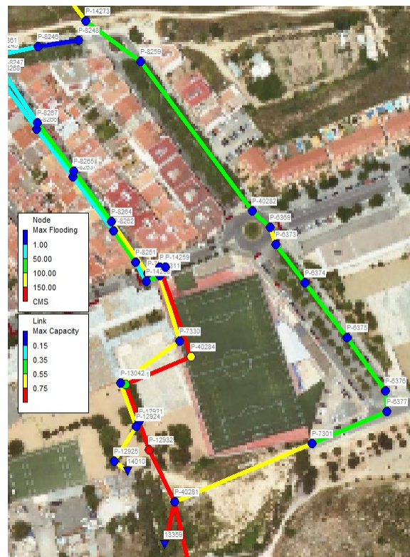
Figura 35. Resultats al tram 2 i 3 amb millores. Es representa el cabal sobreexidor dels pous (l/s) i la ocupació del col·lector (tant per u).
