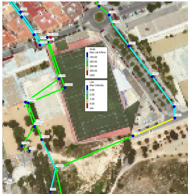
Figura 32. Resultats al tram 3 amb millores. Es representa cabal d'entrada als pous (l/s) i la velocitat del col·lector (m/s).
